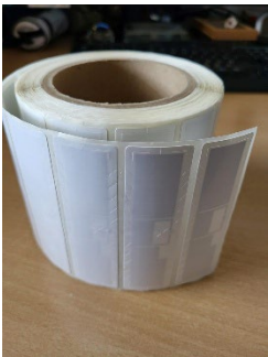
Das Crystal-TE-UHF Smart Label mit Sicherheits-Stanzung
